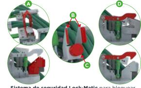
Sistema de seguridad Lock-Matic para bloquear automáticamente la rampa durante el transporte por carretera + cono guía.
